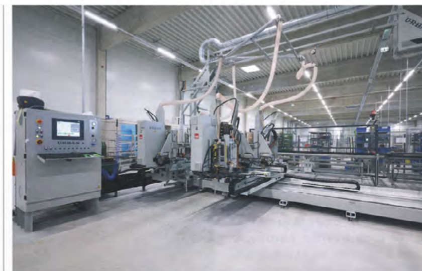
Mit dem Vario Cut AKS 9610 von Urban verfügt die Wilhelm Peine GmbH über eine hochmoderne und leistungsstarke Schweißanlage.
